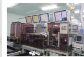
指示計器自動試験装置
